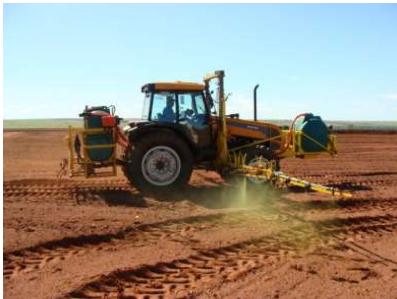
Figura 8 – Pulverização utilizando Concorrente B com bico XR 11003
