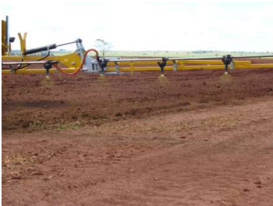
Pulverização com bicos AI 11003 – Trator com equipamento Herbicat (figura 1)
