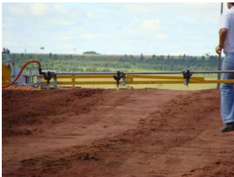
Figura 6 – Pulverização utilizando Concorrente A com bico XR 11003
