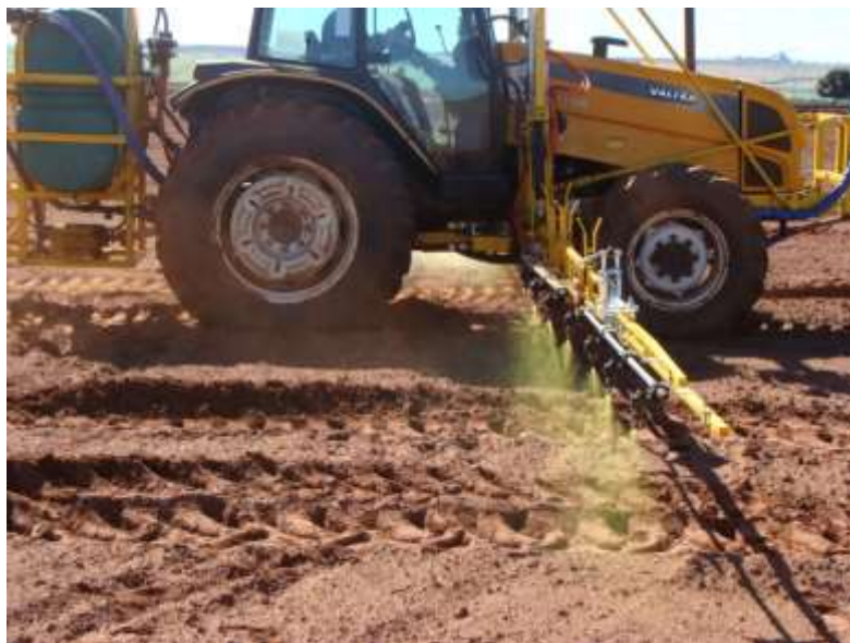
Figura 5 – Pulverização utilizando Concorrente A com bico AI 11003
