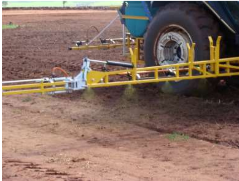
Figura 3 – Pulverização sem uso de adjuvante com bico AI 11003
