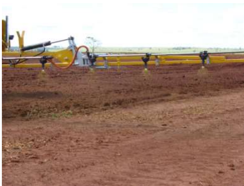
Figura 9 – Pulverização utilizando STARTEC com bico AI 11003
